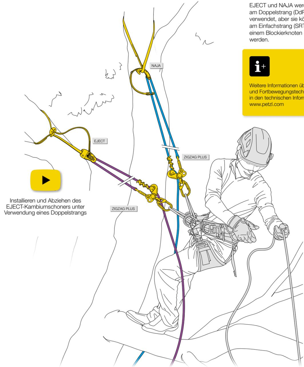
Installieren und Abziehen des EJECT-Kambiumschröners unter Verwendung eines Doppelstrangs
