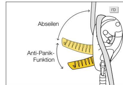
Die für die Höhenarbeit, für schwer zugängliche Bereiche, technische Rettungseinsätze und Evakuierungen konzipierten Geräte verfügen über eine Anti-Panik-Funktion und eine Sicherheitssperre, um im Falle eines Bedienungsfehlers das Unfallrisiko zu reduzieren. Außerdem können sie mit zusätzlichen Bremsselementen kombiniert werden, um die Bremsreibung beim Abseilen schwerer Lasten zu erhöhen.
