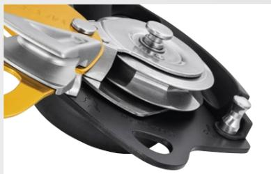
Die Abschrägungen der Laufrolle ermöglichen zusätzliche Kontaktflächen mit dem Seil und eine erhöhte Bremsreibung beim Abseilen/Ablassen schwerer Lasten.
