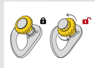
Die manuelle Schraubverriegelung reduziert die Gefahr, dass der Bohrhaken ungewollt herausgezogen wird.
