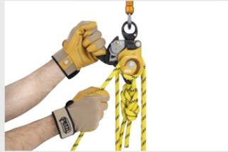
Das Lösen des Klemmnockens und das Führen des Seils um die in das Hauptseitenteil integrierte Bremse ermöglichen ein komfortables und präzises Ablassen der Last.
