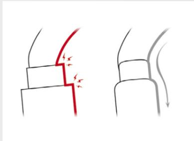
**Kantenfreie Oberfläche an der Innenseite**
