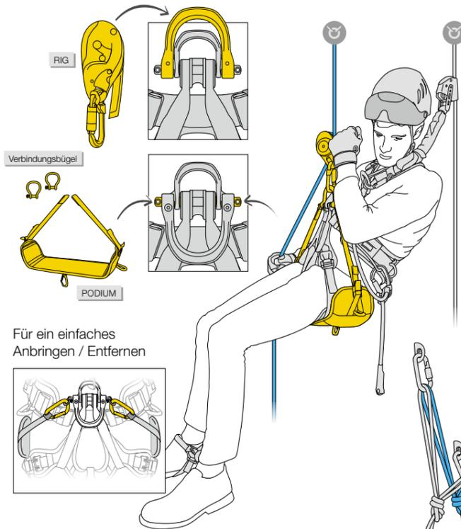
Für ein einfaches Anbringen / Entfernen
