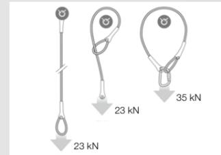
Es bietet mehrere Möglichkeiten zum Installieren einer Anschlagvorrichtung: direkt an einem Anschlagpunkt oder durch Umschlingen einer geeigneten Struktur.
