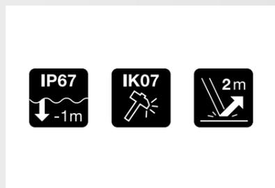
Die ARIA-Stirnlampen wurden speziell für den professionellen Einsatz und dessen Anforderungen konzipiert: dicht (IP67), stoßfest (IK07) und sturzfest bis 2 Meter.
