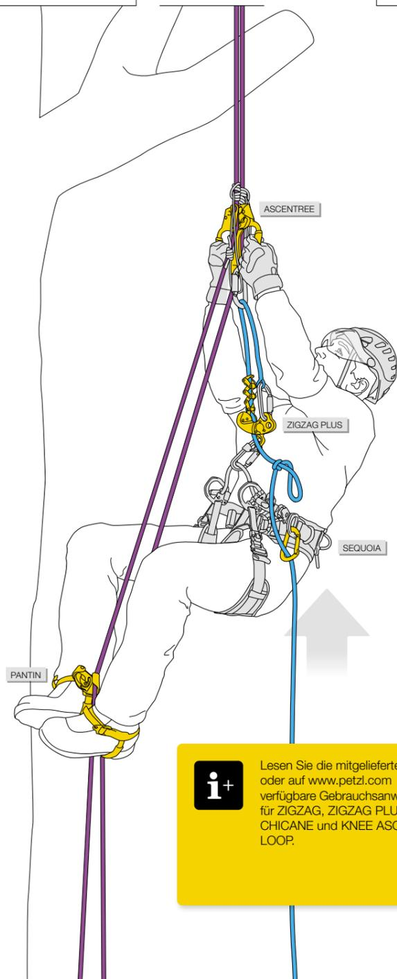
**i+** Lesen Sie die mitgelieferte oder auf [www.petzl.com](http://www.petzl.com) verfügbare Gebrauchsanweisung für ZIGZAG, ZIGZAG PLUS, CHICANE und KNEE ASCENT LOOP.
