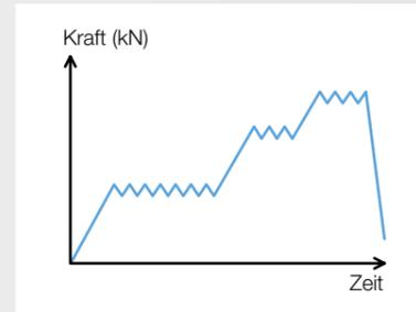
Im Falle eines Sturzes wird der auf den Anwender ausgeübte Fangstoß durch das Aufreißen des Gurtbands des Falldämpfers reduziert. Die Verbindungsmitel sind für Anwender bestimmt, die zwischen 50 und 130 kg wiegen. Durch das progressive Aufreißen des Falldämpfers werden die auf leichtgewichtige Personen ausgeübten Beschleunigungskräfte reduziert.
