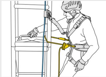
**Befestigung an den beiden seitlichen Halteösen**
