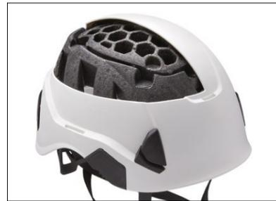
Die Innenschale der STRATO-Helme besteht aus zwei Teilen: EPP (expandiertes Polypropylen) und EPS (expandiertes Polystyrol), um das Gewicht zu reduzieren. Stöße und Schläge werden durch Verformung der Innenschale absorbiert.
