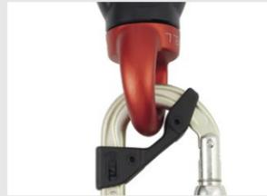
Die ovale symmetrische Form ermöglicht es, den Karabiner bei der Einrichtung von Anschlagpunkten optimal zu positionieren. Die Verwendung des Karabiners mit dem CAPTIV-Positionierungsbügel ermöglicht es, die Belastung des Karabiners in der Längsachse zu favorisieren, ein Verdrehen des Karabiners zu verhindern und zu gewährleisten, dass er eine feste Einheit mit dem Gerät bildet.
