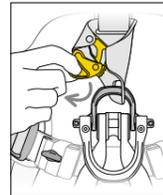
5. Die Rettungskraft hängt im RIG und entfernt die Handsteigklemme. Sie installiert einen Bremskarabiner und begleitet die verletzte Person bis zum Boden.
