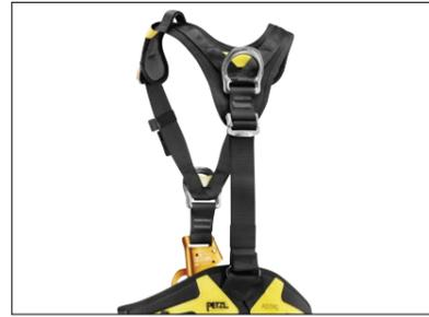
Die ASTRO BOD FAST-Komplettgurte verfügen über eine dorsale Öse zum Einhängen eines Auffangsystems. Im Falle eines Sturzes in diese Öse wird bei kurz eingestellter Länge der Verbindung zwischen Hüftgurt und Beinschlaufen das Gewicht auf die Beinschlaufen verteilt, sodass der Anwender problemlos im Gurt hängen kann, während er auf die Rettung wartet.
