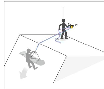
**Ablassen mit zwei parallel installierten MAESTRO, die von einer einzigen Person bedient werden**
