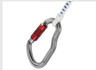
Die unteren Enden sind mit einem STRING-Element versehen, das den Karabiner in der richtigen Position hält und das Gurtband vor Abrieb schützt.
