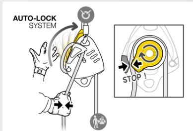
Das AUTO-LOCK-System gewährleistet die automatische Blockierung des Seils, wenn der Hebel nicht benutzt wird. Nach der Blockierung kann ohne Betätigung des Hebels Seil eingezogen werden.
