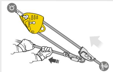
Die integrierte Umlenkrolle mit Rücklaufsperrung und sehr großer Laufrolle mit gekapseltem Kugellager lässt nur eine Laufrichtung zu und gewährleistet einen ausgezeichneten Wirkungsgrad beim Heben von Lasten. Die untere Verbindungsöse ermöglicht das Einrichten unterschiedlicher Flaschenzugsysteme.
