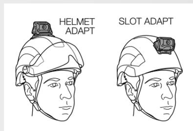
Die ARIA-Stirnlampen können dank ihres Kopfbandes am Kopf oder um den Hals getragen werden. Außerdem können sie mit den als Zubehör erhältlichen Befestigungssystemen an einem Helm befestigt werden: HELMET ADAPT (mit allen Helmtypen kompatibel) und SLOT ADAPT (für Helme mit kompatibler Befestigungsöffnung).
