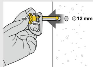
Der Bohrhaken lässt sich ohne Werkzeug schnell und einfach setzen und wieder entfernen, um ihn erneut zu verwenden.
