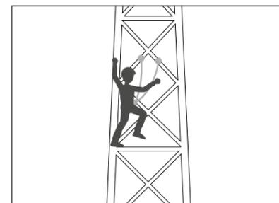
Die zweisträngigen ABSORBICA-Y-Verbindungsmitel ermöglichen es, durch Aus- und Einhängen der beiden Stränge nacheinander permanent gesichert zu bleiben.
