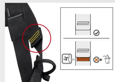
Sternale und dorsale Auffangöse sind mit Sturzindikatoren versehen: Nach einem Sturz ist ein rotes Gewebe sichtbar, was bedeutet, dass der Gurt ausgesondert werden muss.
