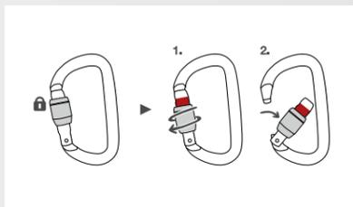
**Manueller Schraubverschluss SCREW-LOCK:**
