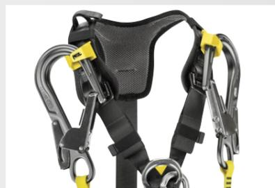
Die Gurte verfügen an jedem Schulterträger über ein Verstauesystem für die Verbindungselemente der Verbindungsmittel zur Absturzicherung. Im Falle eines Sturzes ermöglicht dieses System das Aufreißen des Falldämpfers durch Freigabe des MGO-Verbindungselements.
