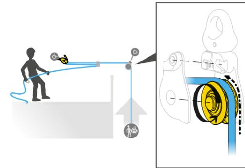
Erhöhung der Bremsreibung, um den Komfort beim Ablassen zu verbessern: Die Laufrolle dreht sich nicht und die Abschrägungen sorgen für zusätzliche Kontaktflächen mit dem Seil.
