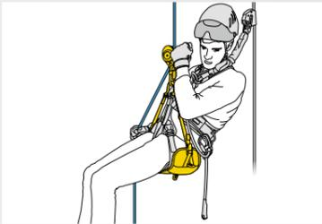
Die vielseitig einsetzbaren, selbstbremsenden Abseilgeräte können sowohl zum Abseilen als auch für kurze Aufstiege am Seil verwendet werden.
