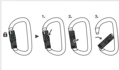
**Automatisches Verriegelungssystem BALL-LOCK:**
