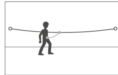
Die einsträngigen ABSORBICA-I-Verbindungsmitel sind u. a. zum Sichern an einem horizontalen Geländerseil oder auf einer Hebebühne geeignet.
